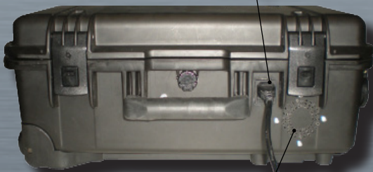
Ventilateur (sortie d'air)
